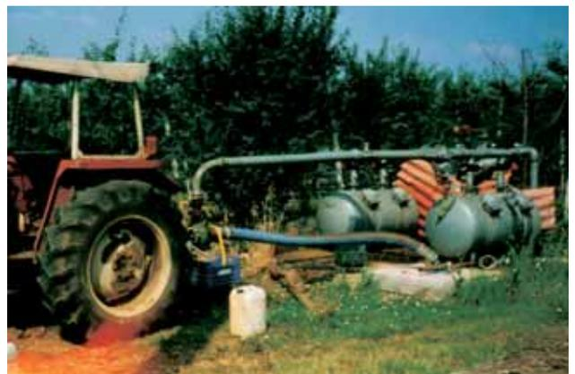
Fig. 2.33 – Particolare dell'accoppiamento trattore-pompa ad asse verticale: il motore del trattore viene preventivamente separato dall'albero e collegato al gruppo rotore della pompa.
