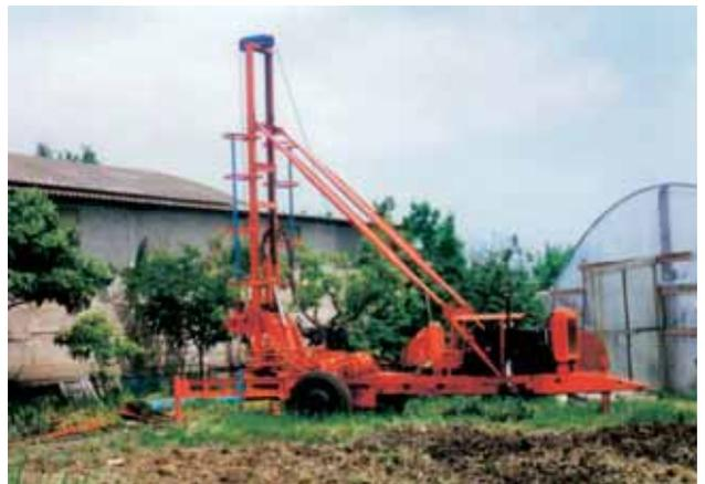
Fig. 2.14 – Impianto di perforazione a rotazione automontato con tavola rotary e pompa del fango, "fatto in casa" da un artigiano locale.
