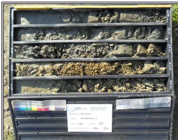
Fig. 6: Esempio di cassetta catalogatrice con all'interno il materiale carotato
