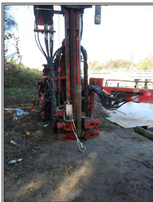
Fig 9: Particolare dell'esecuzione delle prove di permeabilità
