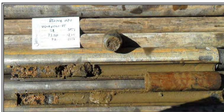
Fig 7: prova penetrometrica SPT(foto sinistra); Campionatore Raimond (foto destra)
