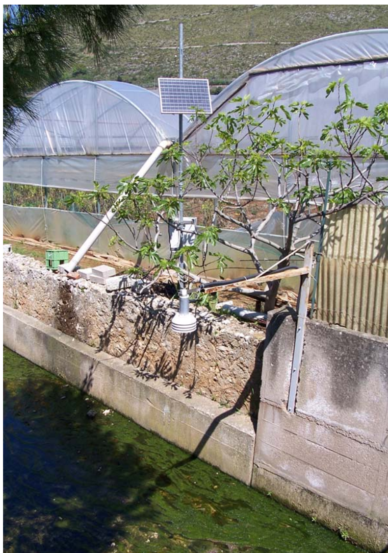
Foto 2 – Particolare della stazione idrometrica (ST15 – Rio d'Itri – Serre)
